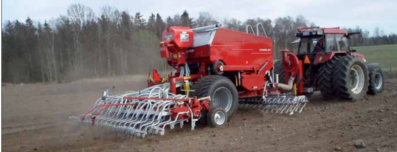
Combi Jet 4504 эта машина способна культивировать уплотнять вносить удобрения и сеять за один проход. На этой фотографии машина оснащена дополнительным бункером для семян травы.
