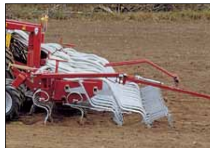
Multi Jet может быть оборудован двумя рядами зубчатых борон расположенных между сошниками.
