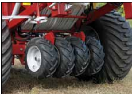
Для уплотнения между LGP колесами, возможно установить серединный колесный уплотнитель.
