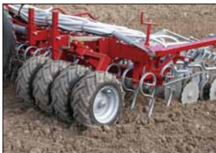
Для уплотнения по всей ширине захвата. Возможно установить боковые колесные уплотнители от 4 до 8 колес для 4, 6 and 8 м ширины захвата.
