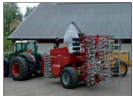
Подпружиненный брезент и большое открывание бункера делает процесс загрузки простым и быстрым.
