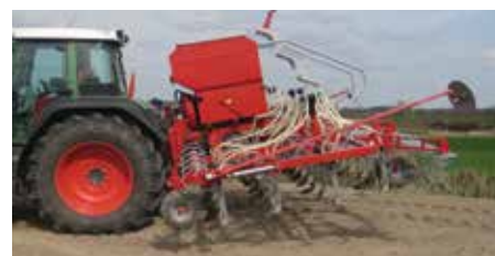
Компактная конструкция обеспечивает нагрузки близко трактору.
