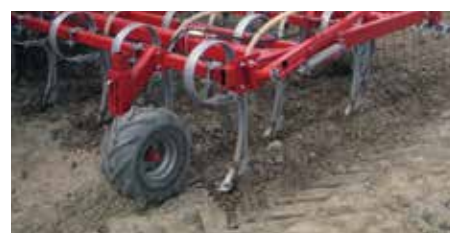
Точный контроль глубины достигается за счет широких колес спереди машины.
