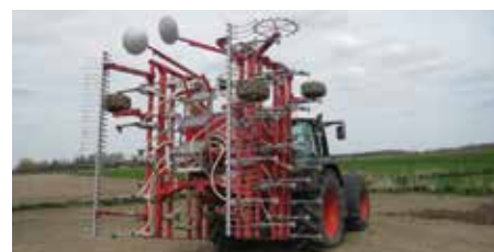
Рама складывающаяся в 2 секции обеспечивает 3,0 м транспортной ширины.
