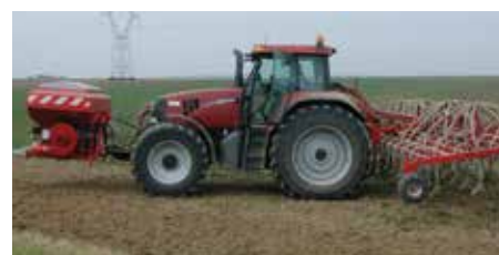
Использование переднего бункера дает хорошее распределение веса.
